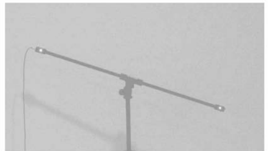
图 3 用于标定的一维靶标图像(局部)
